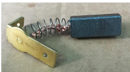
Figura 5d: Inspección de las escobillas de carbono
