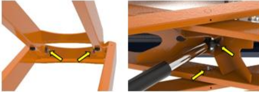
Figura 9.2. Ubicación de los engrasadores del mecanismo de tijeras y los ejes del cilindro.
