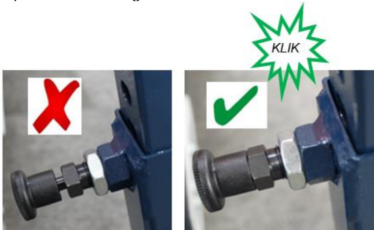
Fig. 8.5 ; MAUVAISE et BONNE fixation de l'axe de verrouillage dans le trou de verrouillage
