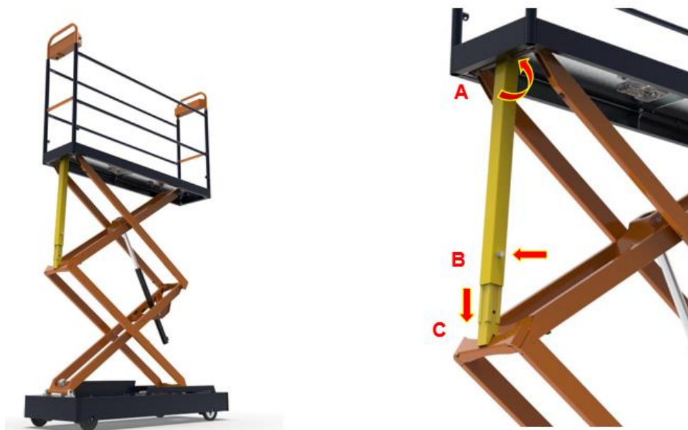
Figure 9.1 ; Utilisation du verrou de pantographe
