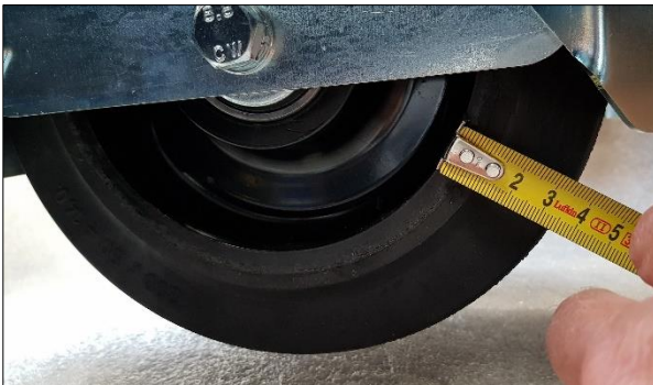
Figure 15 : Contrôle de l'usure, exemple de mesure
