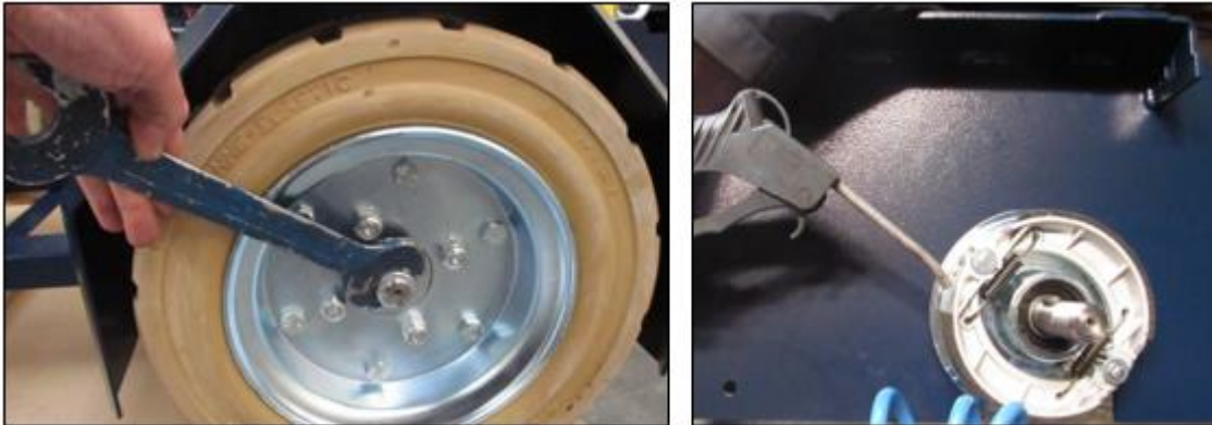
Figure 11 : Démontage des roues
