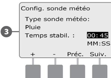
**REMARQUE :** la sonde météo s'active/se désactive au moyen de l'interrupteur Sonde météo (Activée/désactivée) sur le tableau de commande du programmeur.
