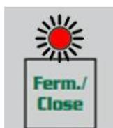
Alors que la lumière **Ferm./Close** clignote **lentement**, appuyer sur la flèche **Dim.** ou **Aug.** selon le temps désirée **en secondes**. Appuyer ensuite sur le bouton **Menu** pour passer à l'étape suivante.
