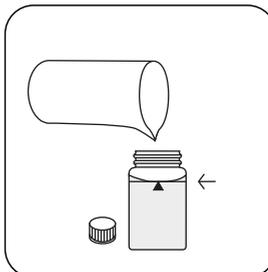
Remplissez la cuvette jusqu'au **repère de 10 ml** en versant l'échantillon.
