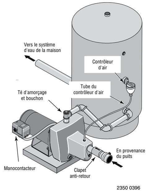
Figure 5 : Branchements sur un réservoir standard
