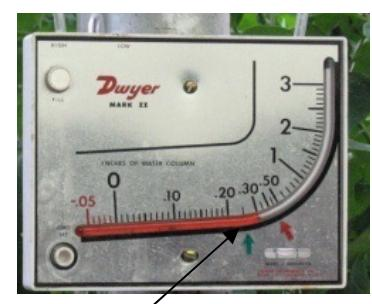
Le manomètre DWYER MARK III permet de mesurer la pression d'air entre les 2 films:
