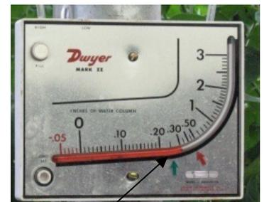
Le manomètre DWYER MARK III permet de mesurer la pression d'air entre les 2 films:
